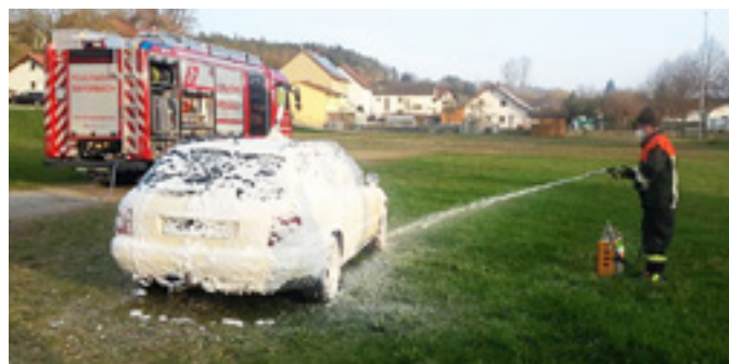
Der Luftschaumlöschers ist besonders handlich und eignet sich dafür, kleinere Brände zu bekämpfen.
